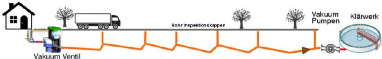
Die verlegten SW-Rohre liegen, dem Gelände folgend, also auch mal bergauf, in der Erde. Im Klärwerk sorgen vier starke Pumpen für das Vakuum in unseren beiden Hauptleitungen. Jedes Haus hat einen Schacht mit einem Vakuumventil.
